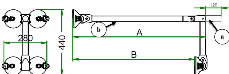
La rallonge de barre de 120mm peut être montée ultérieurement sur le système de barre modulaire Mobeli.
